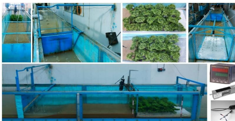
شکل ۱- نمایی از فلوم مستطیلی مدل آزمایشگاهی به همراه جزئیات آن
