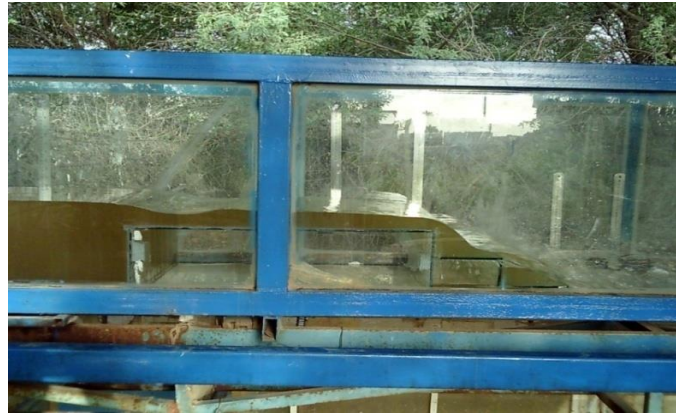
شکل ۴- نمایی از سرریز با ۳ پله، ارتفاع ۲۰ سانتی متر و شیب ۱:۲
