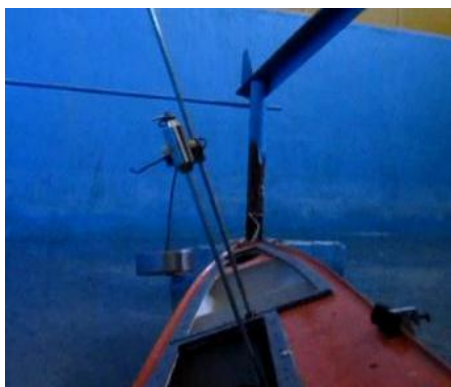
شکل ۴. نحوه قرار گرفتن وزنه و آونگ روی مدل
