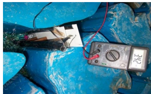
شکل ۵. تولید جریان الکتریکی با چرخش پروانه
