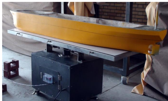
شکل ۴. اندازه گیری ممان اینرسی بدنه خالی مدل با استفاده از میز ممان اینرسی
