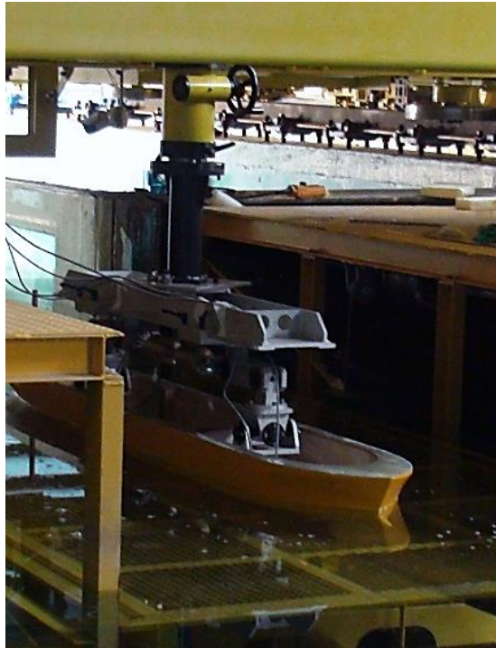
شکل ۵ مدل شناور پس از اتصال به سیستم مانور مقید
