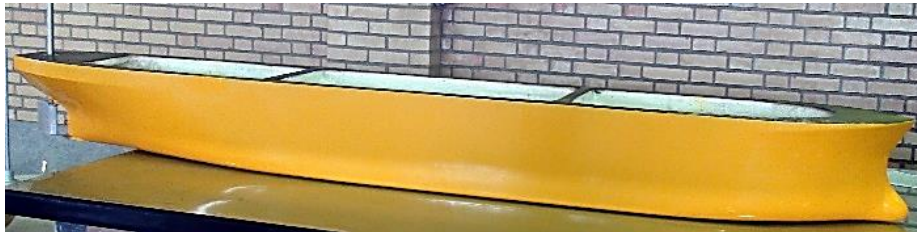
شکل ۳ مدل ساخته شده از شناور اِسو اَزاکا
