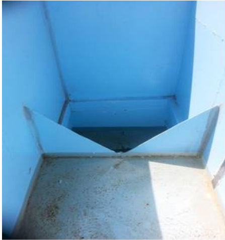
شکل ۳- سرریزهای ورودی و خروجی مثلثی با رأس ۹۰ درجه، در ابتدا و انتهای فلوم
